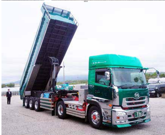
久保建材工業が保有する「ダンプトレーラー」④とダンプアップ時の様子
